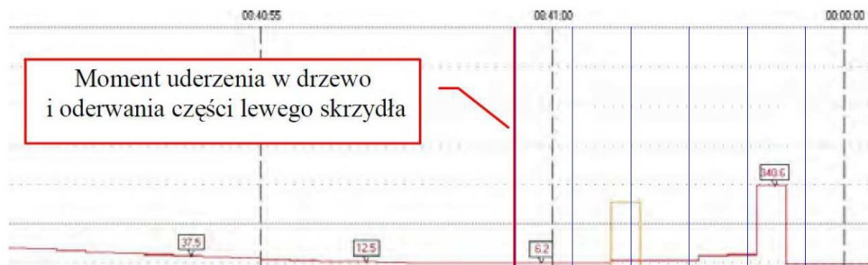
Rys. 17. Przebieg wybranych parametrów na ścieżce podejścia do lądowania – kanał poprzeczny – sterowanie lotkami
